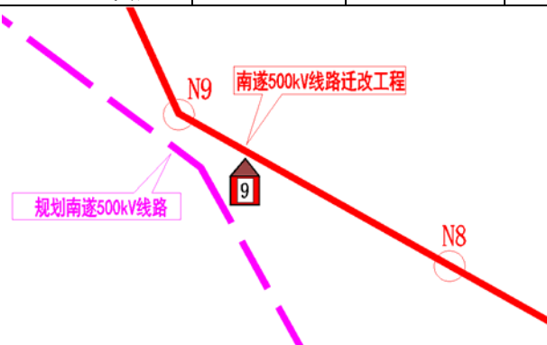
图3-3 本线路与规划遂宁~南充 500kV 线路并行段示意图
