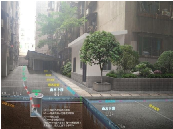
图 5-6 透水混凝土路面结构图（复丰巷）
