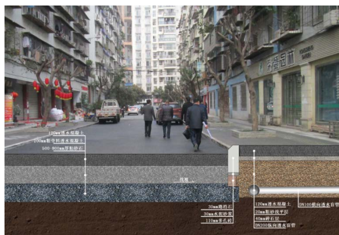
图 5-17 典型整体透水混凝土道路效果图
